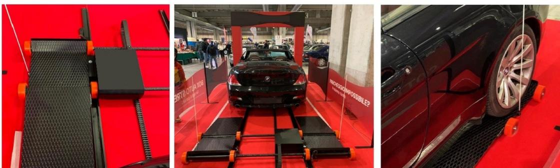
accoglie sulle sue pedane l'asse di trazione dell'autovettura e esegue la sua funzione trascinando qualsiasi tipo di autoveicolo con inserita la marcia neutra (folle).
