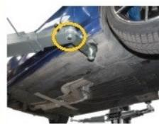
L'ingombro del braccio è ridotto al minimo, permettendo di lavorare senza ostacoli nel sottoscocca, anche in parti del veicolo come ruote, freni e sospensioni.
