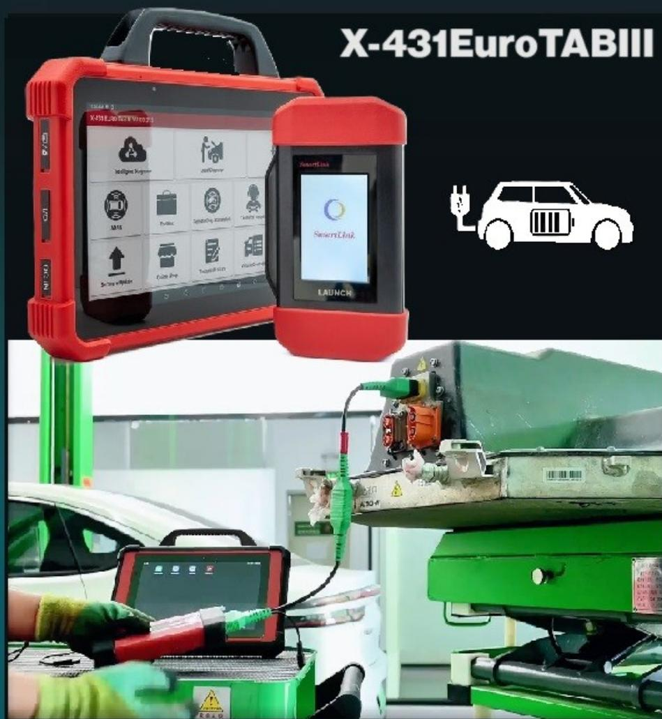
Sollevatore elettromeccanico **OMCN 199/RX** + Set di forche **N199/RX** utili per il sollevamento del veicolo elettrico dalle ruote durante la sostituzione del pacco batterie
