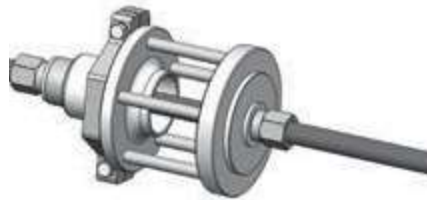
2 Smontaggio ghiera interna del cuscinetto dal mozzo ruota
