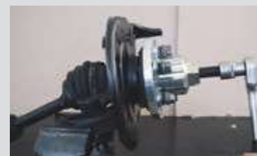
Estrazione meccanica dell'albero di trasmissione a banco
