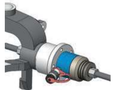
3 Smontaggio del vecchio cuscinetto della ruota dal raggio dell'asse
