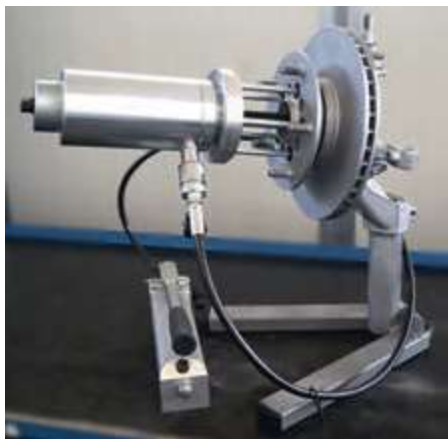
Smontaggio unità cuscinetto ruota - dischi del freno - mozzi ruota - cambio disco del freno
