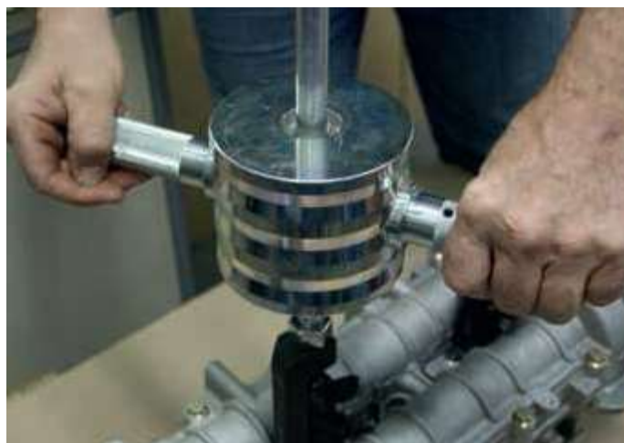
Estrazione di iniettore diesel
