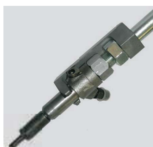
Estrazione di iniettore diesel
