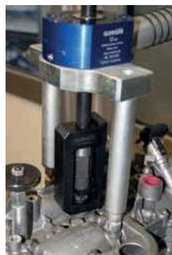
Estrazione con cilindro mecadraulico 12T GO1015 (optional)
