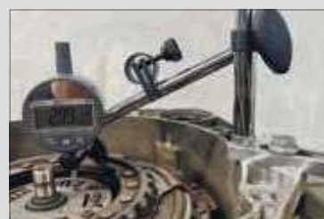
Controllare il gioco in altezza della frizione DSG
