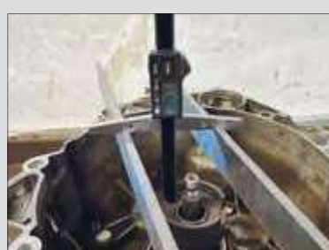
Misurazione della profondità di montaggio K2 (Attenzione: il calibro mostrato non è compreso nella fornitura!)
