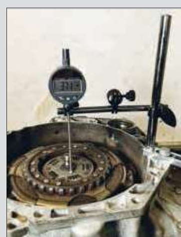
Test di gioco verticale con estensione del sensore
