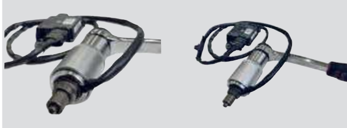
Sensore con inserto a chiave e presa
